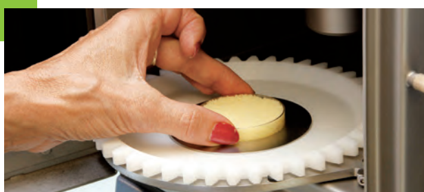
> Le matin suivant : les laborantines soumettent les échantillons prélevés à la mesure du Food Scan, tout spécialement calibré pour le Comté.
