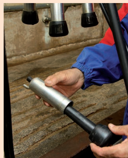
Changement des manchons sur la griffe de traite.
