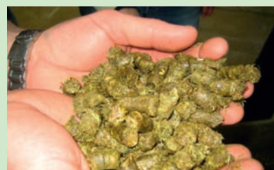
L'herbe coupée passe dans un sécheur à basse température avant d'être transformée en granulés.
