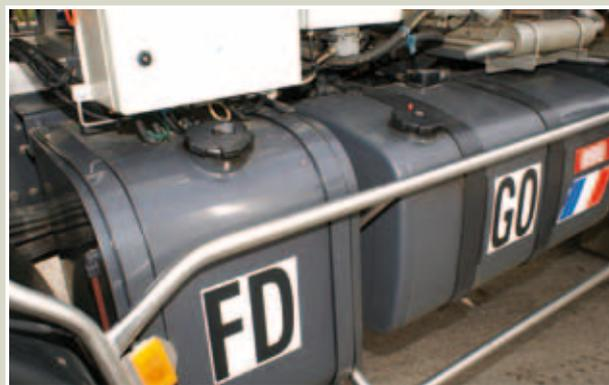
Des camions équipés de doubles réservoirs. Pendant le ramassage du lait dans les fermes, le camion fonctionne au gasoil détaxé.
