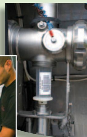
Prise d'échantillon automatisée directement sur le camion de ramassage, avec rinçage de la seringue entre chaque producteur. Le prélèvement manuel ne concerne plus que 25 % des fruitières. La traçabilité est assurée par un code-barres apposé sur le flacon.
